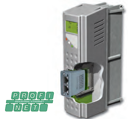
» Insert the Profinet module
